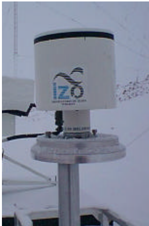
Figura 1 - Radiómetro multicanal de ancho de banda moderada NILU-UV6 en Belgrano (NILU-UV6 multichannel moderate bandwidth filter radiometer at Belgrano.)
